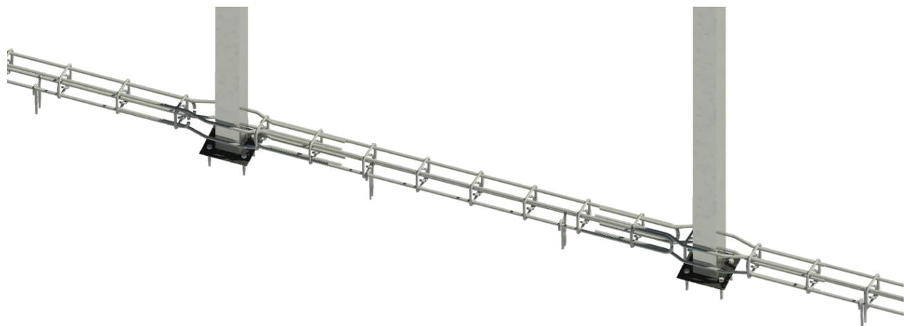
*Ilustración 22 Vista 3D de armadura metálica en sección de viga*
